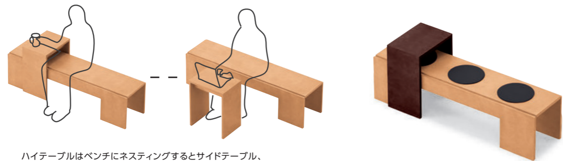
ハイテーブルはベンチにネスティングするとサイドテーブル、 独立させるとデスクになります。
